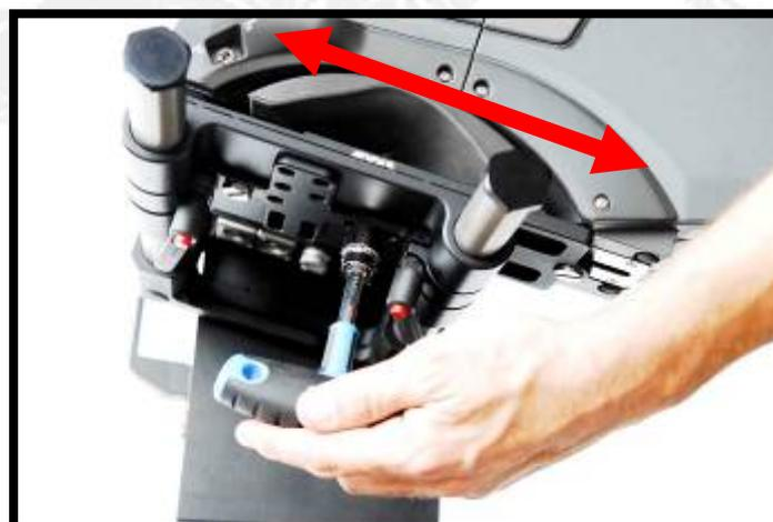
Para equilibrar el PAN, se pone la cámara en posición vertical y mediante las barras largas de la "L" se equilibra el sistema.
