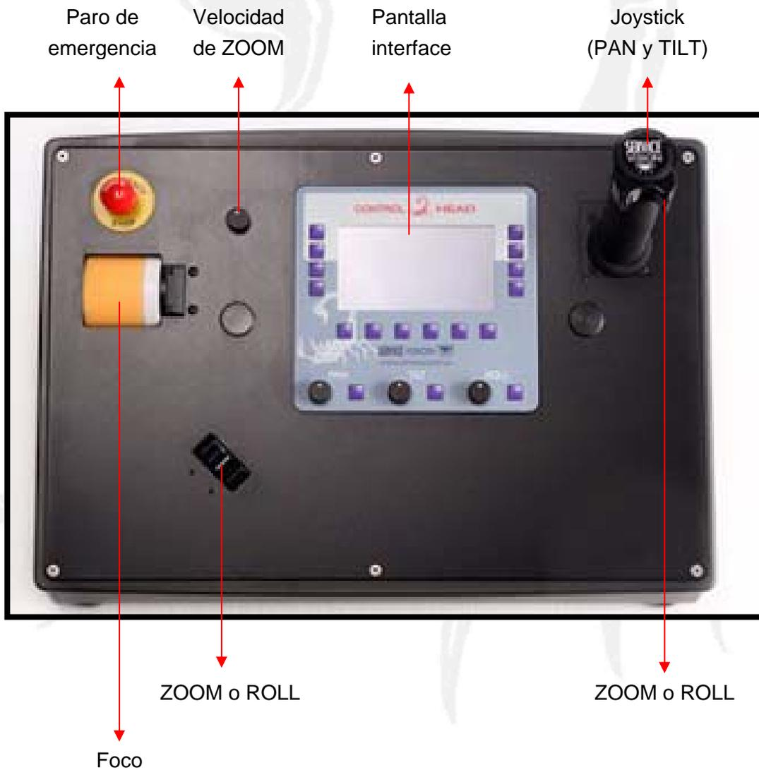
El número de controles se pueden ampliar mediante accesorios, como por ejemplo el pedal que conectaremos en JDR ROLL.
