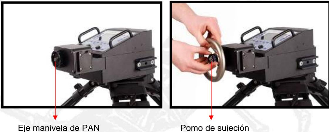
La dureza de giro de todas las manivelas se podrá graduar mediante un sistema de fluidos. Se ajustará mediante el regulador de fluido que hay ubicado entre cada manivela y el cuerpo principal.
