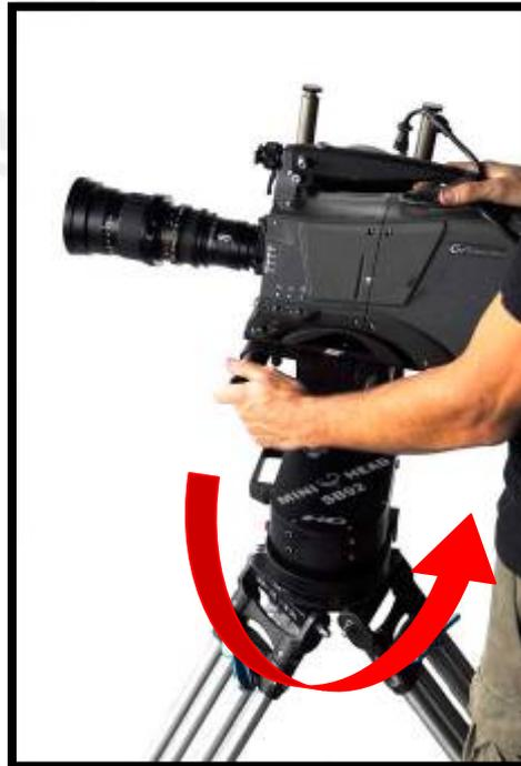
En el caso de dos ejes el movimiento de cámara se debe hacer directamente sobre la base de la cámara.
