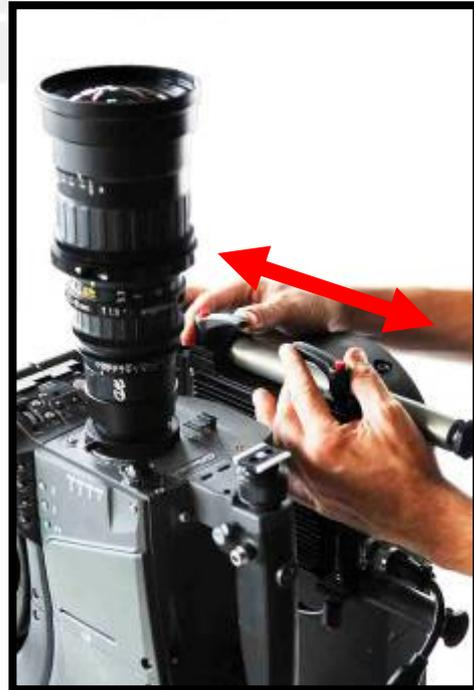
En caso de tres ejes, el movimiento de cámara se puede conseguir también con el desplazamiento de la plataforma portacámara sobre sus propias barras de sujeción.
